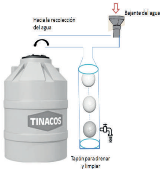
Sistema de separación de primeras aguas de lluvia.
